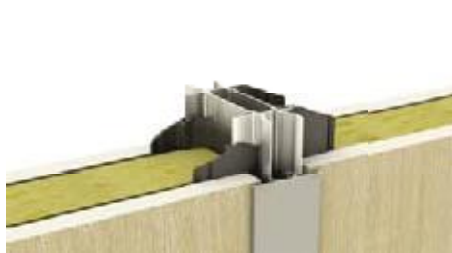
BF13 užpildas+ „AcousticClip“ ir 45 mm arba 55 mm storio stiklo vata.
