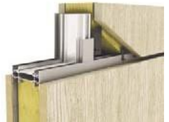
S9 spaustukai leidžia prie rėmo pritvirtinti medienos plokštę su apvadu padengtas kraštais. Įleistosios jungties apatinę dalį slepia lakuota dengiamoji juostelė.
