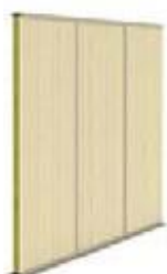
Vientisosios plokštės sujungtos plona vertikalia įleistąja jungtimi.
