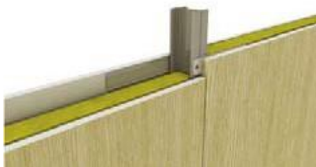
Plieninė plokštelė priklijuojama vienoje gipso kartono plokštės plonintais kraštais pusėje.
