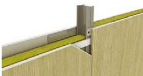
Plieninė plokštelė klijuojama ir dedama į išdrožą ties kitos gipso kartono plokštės kraštu.
